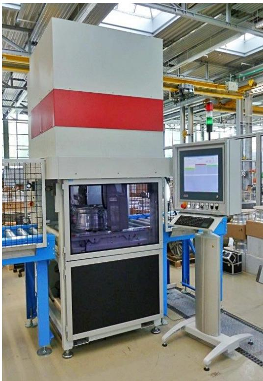
in sein Spezialgebiet der Messtechnik an Kfz-Rädern. Anfang der 2000er Jahre hat er ein schnelles laseroptisches Messsystem entwickelt, dass nachträglich in bestehende Fertigungslinien integriert werden kann.
